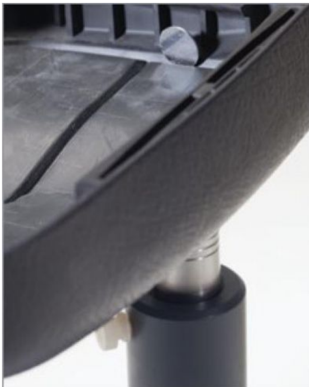
Abbildung 2: Position des Messkopfs an der Außenseite einer Airbagklappe.
